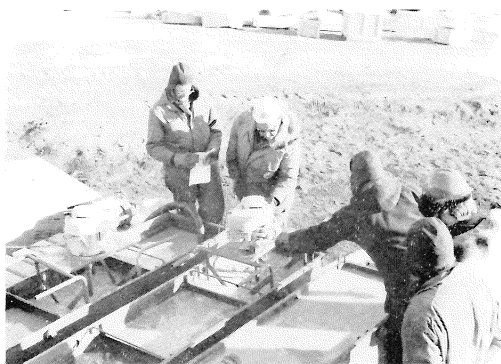
写真 ボーリング用循環水の貯水槽
