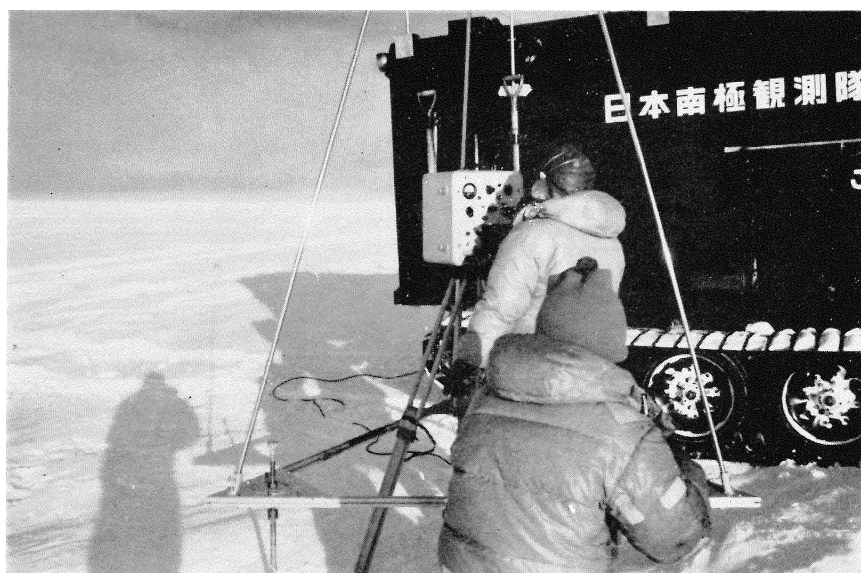
写真-3 電波測距 儀(エレクトロテープ) にて距離を測定する。
