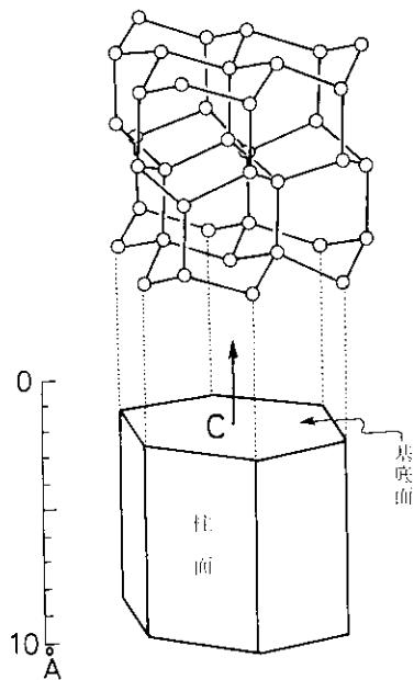
第2図 水の結晶構造。上の図の白丸は水分子の中の酸素の位置、水素はこれらをつなげる線上にある。下の図の六角柱が氷結晶の単位の大きさを示す。柱の縦方向がC軸方向、それに垂直な面が基底面。
