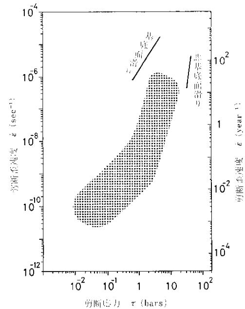
第3図 氷の応力・歪速度の関係を求めた実験結果。上方の二つの直線は、単結晶について基底面滑りの場合と非底面滑りの場合。下の陰影部は多結晶について多くの実験結果の入る範囲
