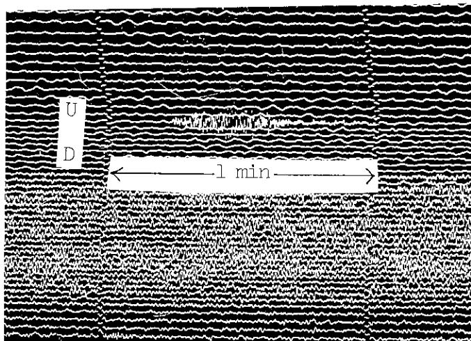
第 4 図 HES 地震計に記録された近地地震 (II 型)
