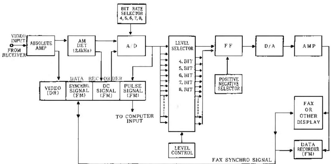
第4図 赤外線地表放射量解析装置のブロック図
