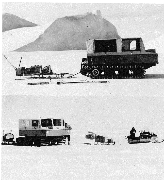
写真—3 上) 浮上型雪上車 SM-15 とスキー装着軽機、手前は アイスオーガーの刃と水中用送受波器。 下) SM-15 と軽機、スノーモービルと軽機。行動は 迅速かつ軽快。
