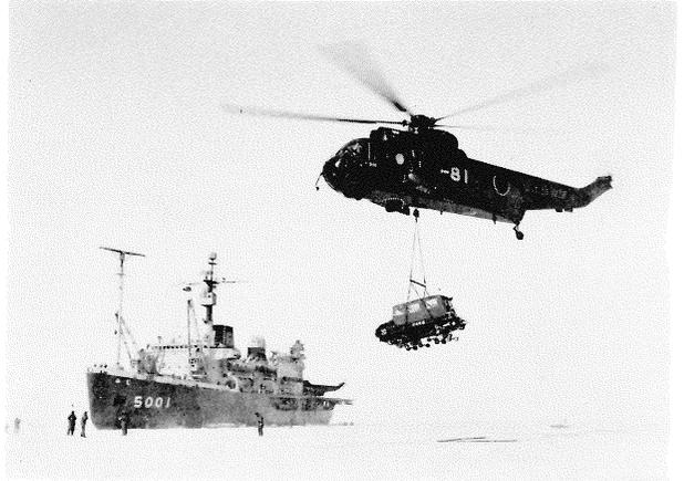
写真-7 ヘリコプターによる大型物資のスリング輸送
