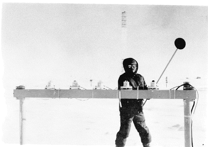
写真-3 放射計の検定をする山内隊員（みずほ基地）。放射観測としてこれほど集中的に観測した例は南極ではないのではないかと思います。
