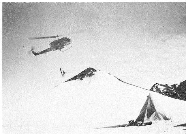
写真—5 ヘリコプターオペレーション リバティールズのキャンプからキャンプへ、スノーモービルをつり下げて運んでいるところ
